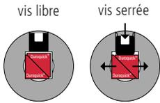
La tige DUROQUICK® se compose de deux profils triangulaires, garantissant une fixation sans aucun jeu même dans les poignées que dans la serrure.
